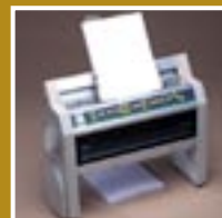
obr. 4 Tiskárna textu ve slepeckém písmu Index Everest (ve spojení s počítačem)
