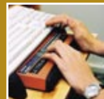
obr. 5 Braillový řádek pro čtení informací z počítače pomocí slepeckého písma (ve spojení s počítačem)
